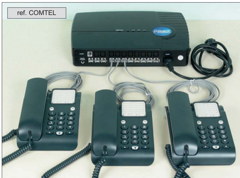
Exemple de configuration avec 2 postes téléphoniques analogiques.
